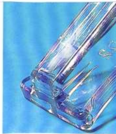
Tache mate [effet de couronne] près du point d'injection
