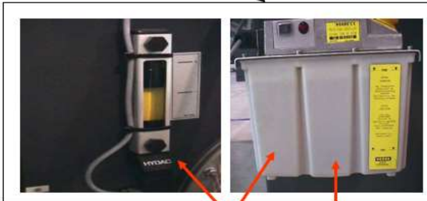
Fig 7 Vérification des niveaux d'huile ( attention: huile spéciale graissage)
