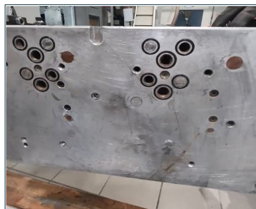
GRAISSER LES JOINTS TORIQUES SUR LE MOULE
